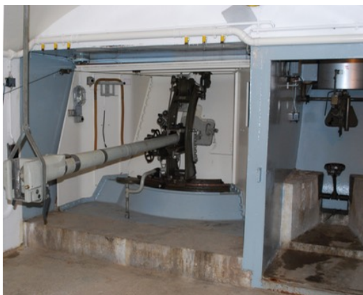
Le canon antichar 1950 de 90 mm sur affût à flasques. Pendant les tirs, les servants doivent porter un masque de protection branché sur le système de ventilation de l'ouvrage (les 6 embouts jaunes sur la photo), à cause du monoxyde de carbone que dégage le tir au canon et à la mitrailleuse.
